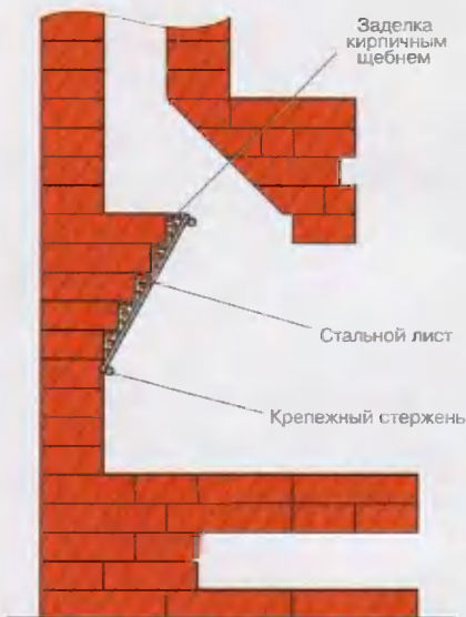
Рис. 3. Устройство задней наклонной стенки топливника из стального листа.
