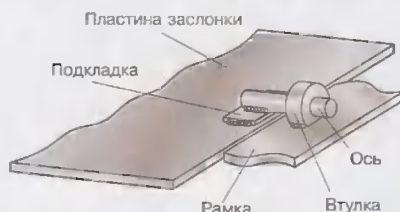
Рис. 2. Узел шарнира вращения заслонки.
