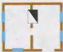
Рис. 1. Отопительно-варочная печь расположена в перегородке между помещениями дома.
