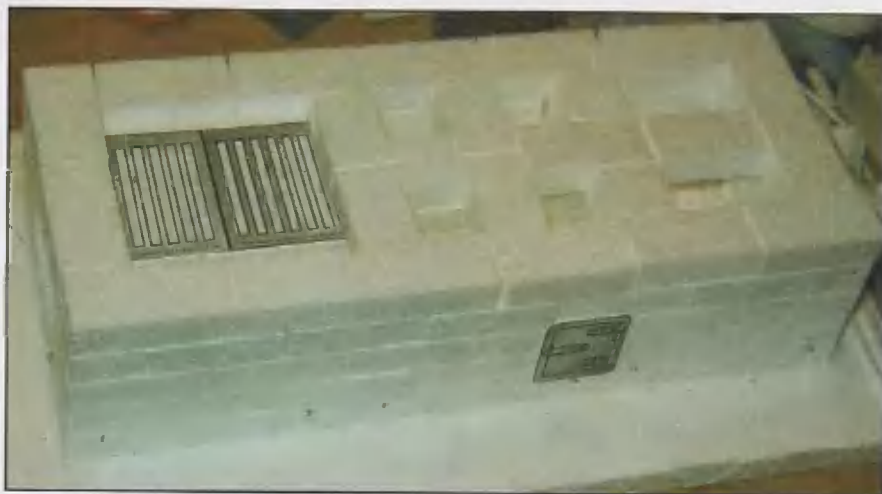
Предварительный макет печи в масштабе 1:5, сделанный из комплекта полистироловых кирпичиков. На фото видно, что установленные на тычок кирпичи в поддувале образуют нишу для установки колосниковых решеток топки.
